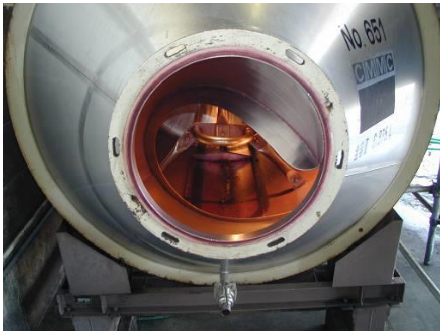
回転式発酵タンクの内部（螺旋状の羽がブドウを攪拌する） <写真提供：丹波ワイン（下2点）>
